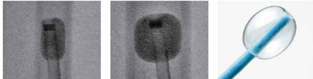
内径6mm血管モデル内のバルーン拡張
